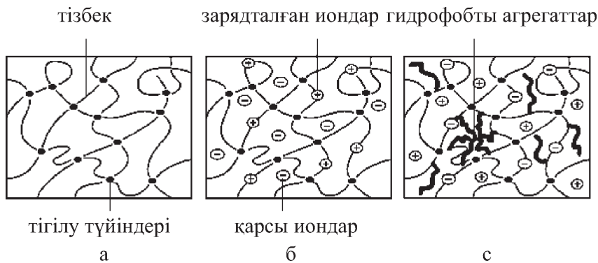
6.19-сурет. Полимерлік гельдің үш пішінінің құрылым сызбанұсқасы а-зарядталған тор келтірілген, б-полиэлектролит бейнеленген
